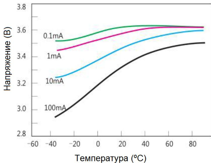
**Зависимость емкости элемента питания от температуры и тока разряда:**
