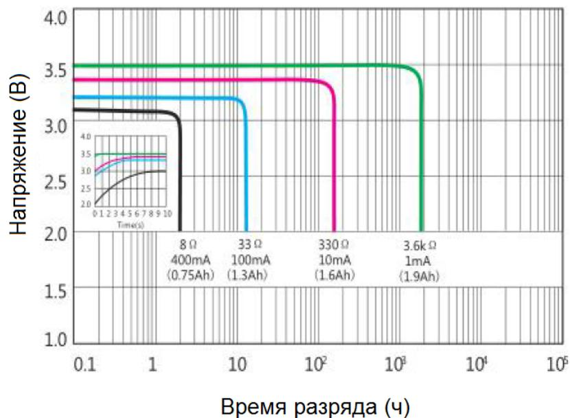
**Зависимость напряжения на элементе питания от тока разряда и температуры:**
