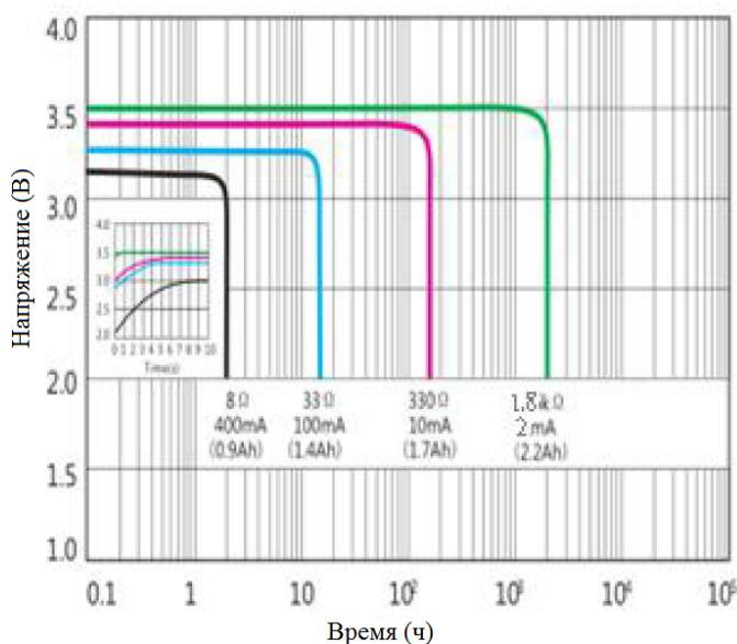
Зависимость напряжения на элементе питания от температуры элемента питания и тока разряда:
