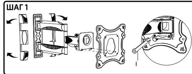
**ШАГ 1:** Снимите декоративные пластиковые наклейки с основания кронштейна просто раздвинув их в стороны. Используя ключ J, открутите 2 винта из задней части площадки крепления к ТВ и демонтируйте её, потянув вверх.
