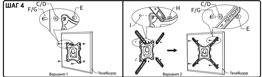
**ШАГ 4:** Подберите подходящие по диаметру для ТВ винты из комплекта кронштейна, при необходимости применяя шайбы C или D. Приложите телевизионную площадку кронштейна к задней части телевизора так, чтобы её отверстия совпадали с отверстиями в ТВ. Используя между направляющими и ТВ пластиковые втулки E, предотвращающие повреждение, закрутите выбранные винты. В зависимости от креплений VESA есть 2 варианта крепления площадки к ТВ:
