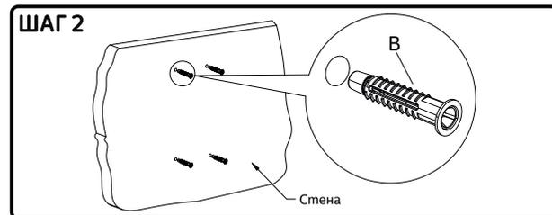
**ШАГ 2:** Приложите в желательном месте установки кронштейн к стене как шаблон для того, чтобы разметить места сверления. Используйте соответствующий инструмент со сверлом Ø 10мм, просверлив на глубину не более 80 мм. Затем установите в проделанные отверстия в стене пластиковые дюбели B из комплекта.
