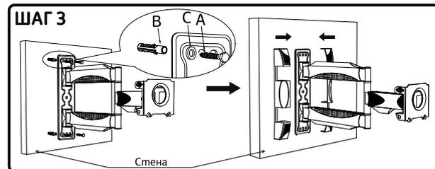
**ШАГ 3:** Установите кронштейн к стене и закрутите через него в проделанные отверстия с пластиковыми дюбелями шурупы A через шайбы C плотно прикрутив площадку к стене. После этого установите обратно пластиковые наклейки, соединив их до характерного щелчка.
