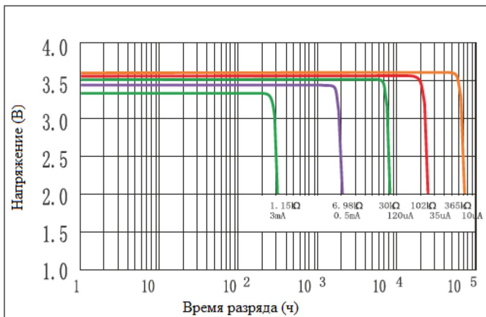
Зависимость напряжения на элементе питания от тока разряда и температуры
